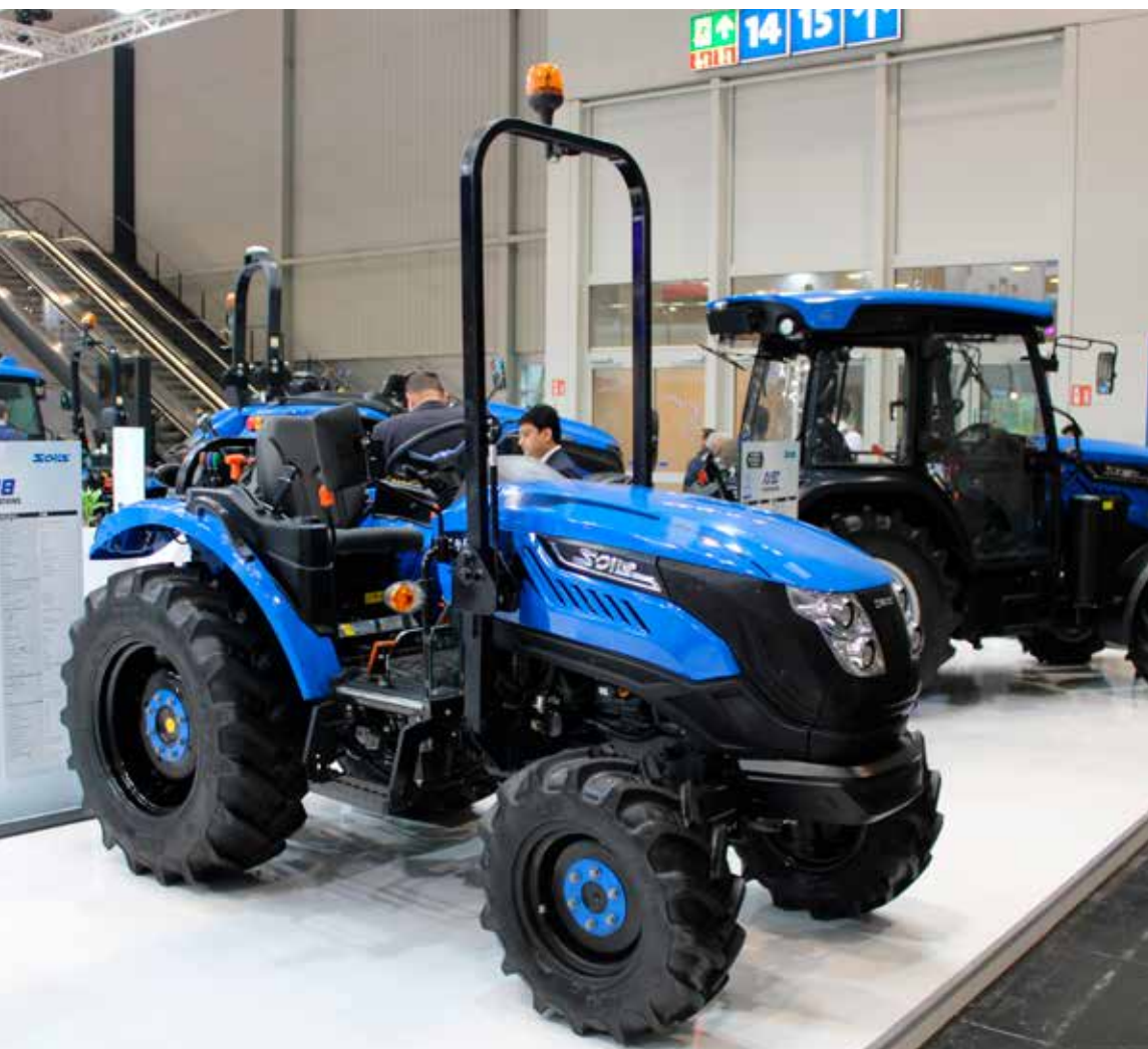
Ciągnik C48 napędzany jest 4-cylindrowym silnikiem Yanmar Make o pojemności 2190 cm 3 i mocy 46 KM.
