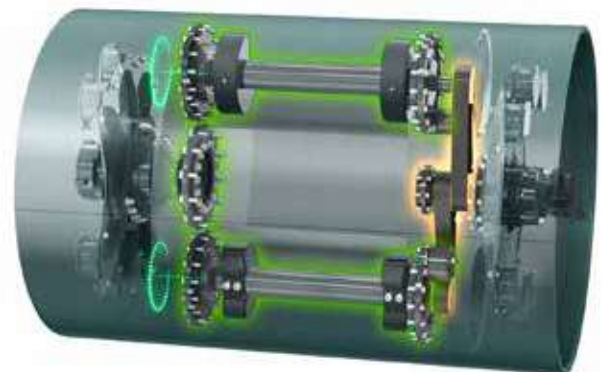
Walec tandemowy HD+ 120i V-VIO 12 t jest wyposażony w bęben wibracyjny z przodu i bęben VIO z tyłu.
