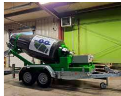
E-Selftoupie to montowany na przyczepie elektryczny minimieszalnik.
