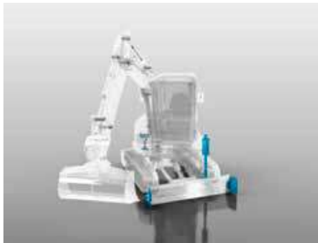
DMS Technologie - Sterowanie lemieszem koparki (EBC).
