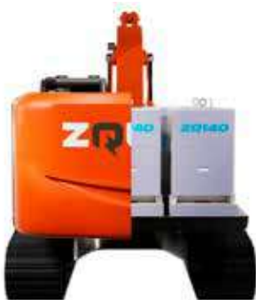
ZQuip - modułowa platforma typu plug and play, która zastępuje silniki wysokoprężne.
