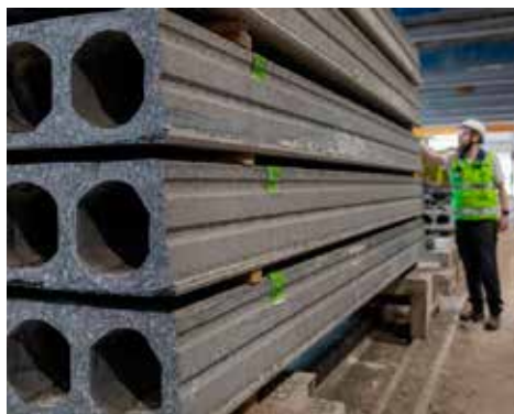
Geoprime Hollow-Core Slab przekształca wcześniej niewykorzystane materiały przemysłowe o dużej objętości w substytut cementu.
