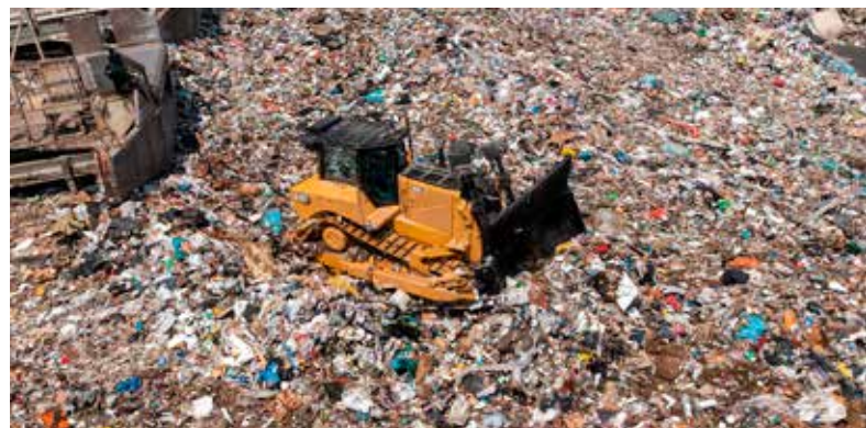
Specjalna wersja spycharki na wymagające warunki, jak wysypiska, z osłonami, wzmocnionym chłodzeniem i dedykowanymi lemieszami dla maksymalnej trwałości i wydajności.
