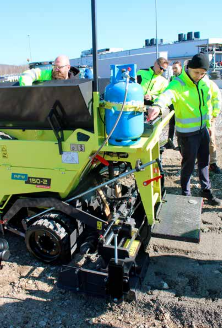
AFW 150-2 – rozściełacz asfaltu marki Ammann zaprojektowany z myślą o precyzji i komforcie operatora, wyposażony w nowoczesne systemy kontroli jakości oraz udoskonaloną ergonomię obsługi.
