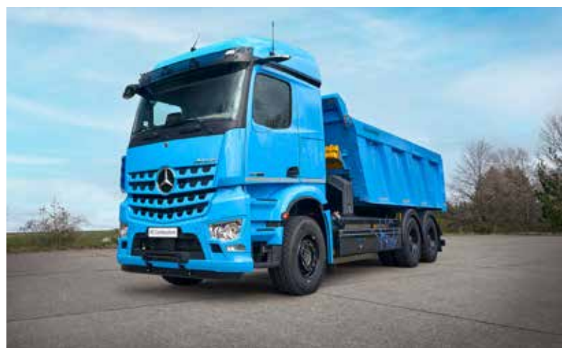
Pojazd rozwojowy Mercedes-Benz Arocs z silnikiem wodorowym w warunkach rzeczywistego placu budowy.
