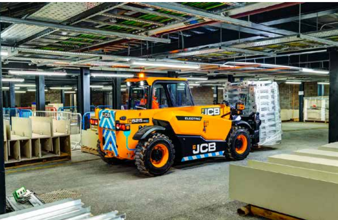
JCB TH 525-60E to elektryczna ładowarka teleskopowa, zasilana akumulatorem litowo-jonowym o pojemności 24 kWh i napięciu 96 V, wyprodukowanym przez Jungheinrich, co pozwala na pełny dzień pracy bez emisji spalin.
