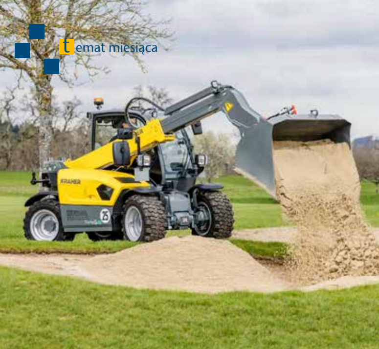
Ładowarka Kramer 1445e oferuje nominalny udźwig 1,45 t, przy maksymalnym wysięgu 725 kg, a maksymalna wysokość podnoszenia wynosi 4,3 m.
