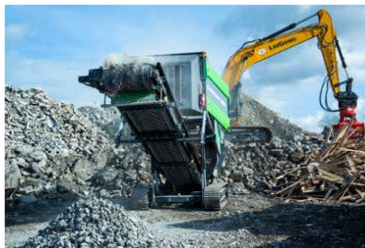
EvoQuip Cobra 290R - kompaktowa kruszarka udarowa z przesiewem końcowym do pracy w jednym przejściu.
