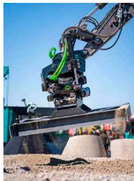
Belka profilująca Steelwrist umożliwia szybkie i precyzyjne niwelowanie dużych powierzchni.
