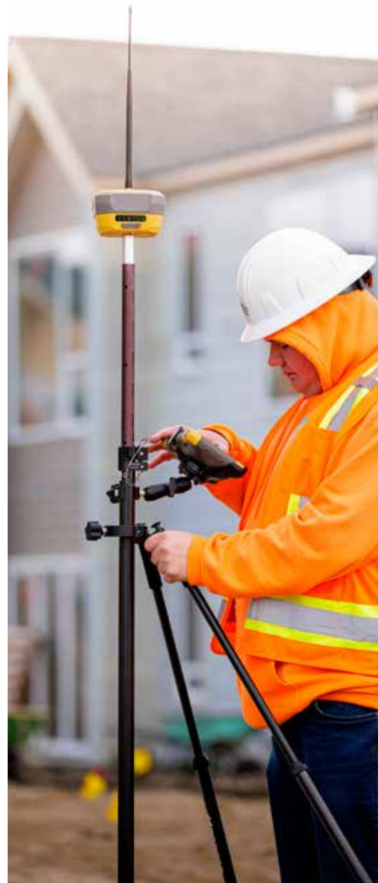
Topcon HiPer XR podczas pracy terenowej - lekka konstrukcja (<1 kg) ułatwia wielogodzinne pomiary.
