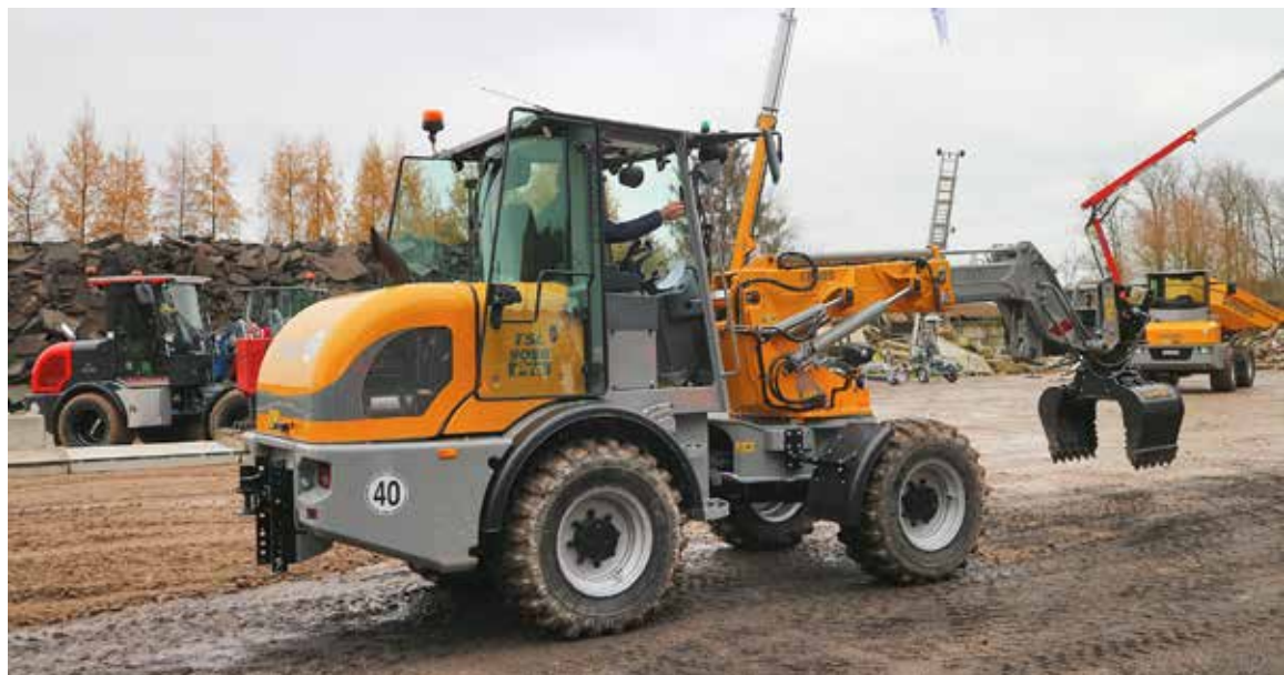
Paus TSL 9088 Pro z obrotowym wysięgnikiem 90° podczas pracy na placu budowy.
