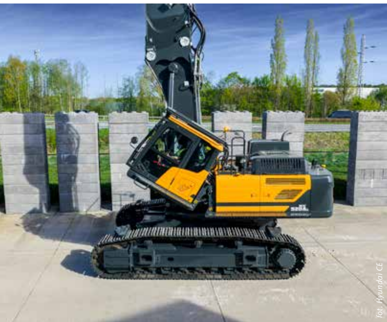
W konfiguracji wysokiego zasięgu HX520A HRD wykorzystuje wysięgnik główny o długości 13,25 m, ramię środkowe 2,7 m i ramię końcowe 9,5 m.
