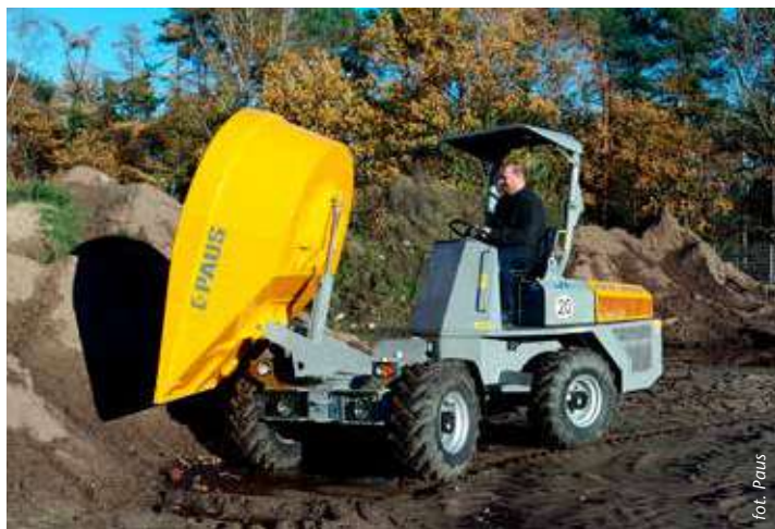
Wozidło AKR 9040 pozwala na boczny rozładunek do 4000 kg materiału dzięki skrzyni obracanej o 180°.
