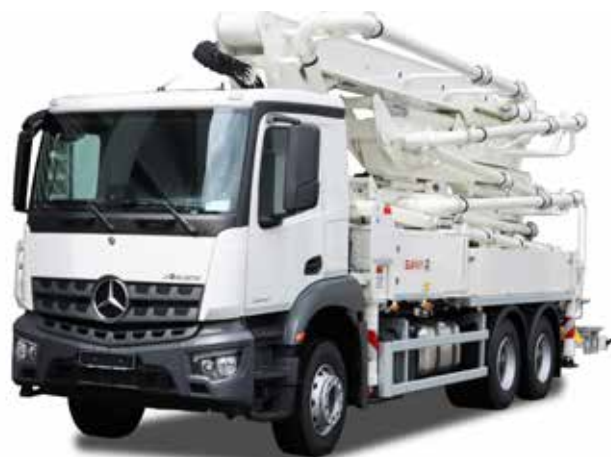
Jednostka pompująca osiąga maksymalnie 155 m 3 /h przy ciśnieniu 80 bar.
