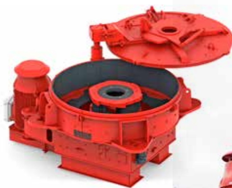
Rewersyjne kruszarki SMR mogą pracować jako drugi i trzeci stopień kruszenia. Ich wydajność wynosi 70-300 t/h.
