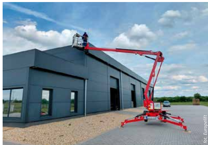
Podpory Europelift TM13GTi pozwalają ustawić maszynę na terenie o nachyleniu do 6,8°, czyli 12%.
