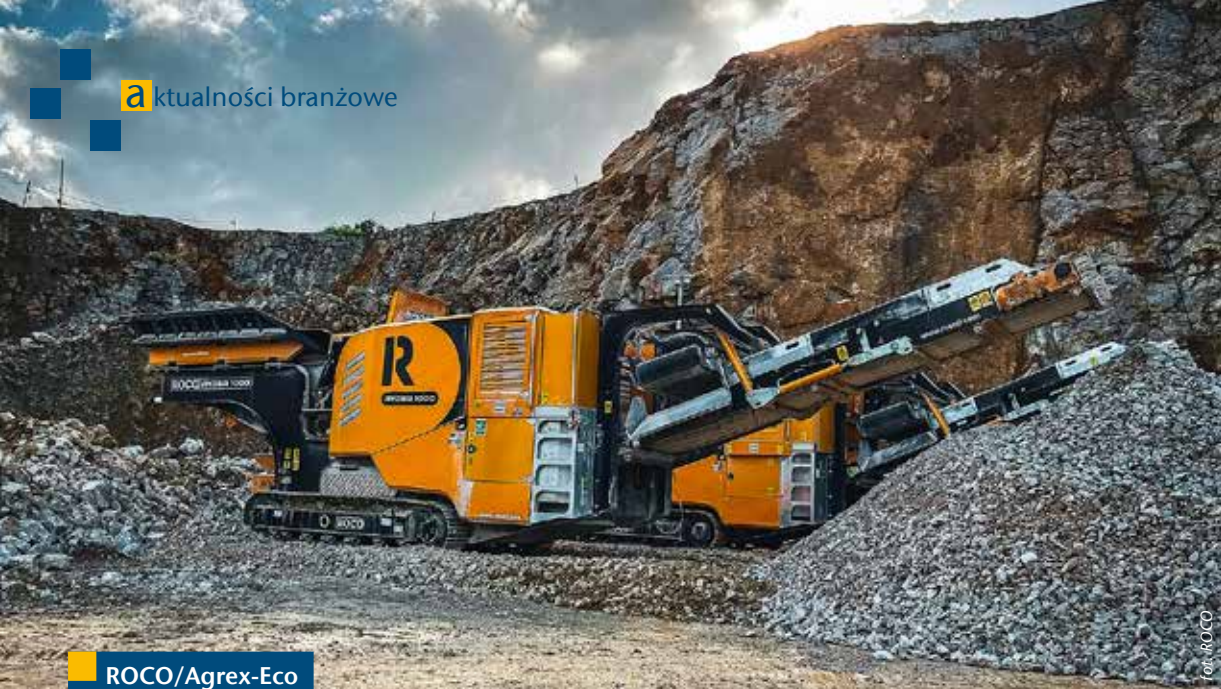
Mobilna kruszarka Ryder 1000 jest przeznaczona do zastosowań w branży wydobywczej i recyklingowej.
