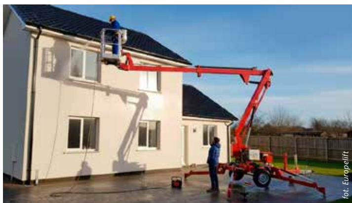
Europelift TM13GTi osiąga 13 m wysokości roboczej i zapewnia do 7,1 m wysięgu bocznego.
