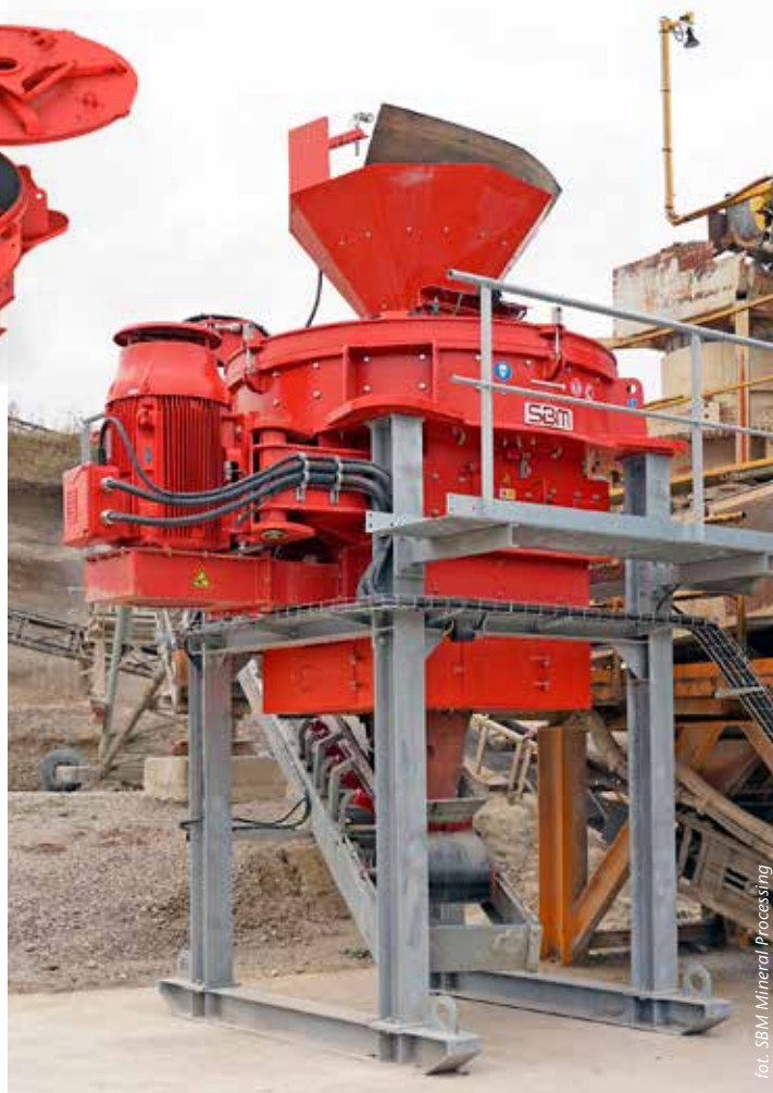
Rewersyjne kruszarki SMR mogą pracować jako drugi i trzeci stopień kruszenia. Ich wydajność wynosi 70-300 t/h.
