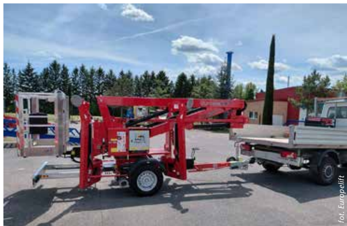
W położeniu transportowym podnośnik ma 5,2 m długości, 1,5 m szerokości i 1,99 m wysokości.
