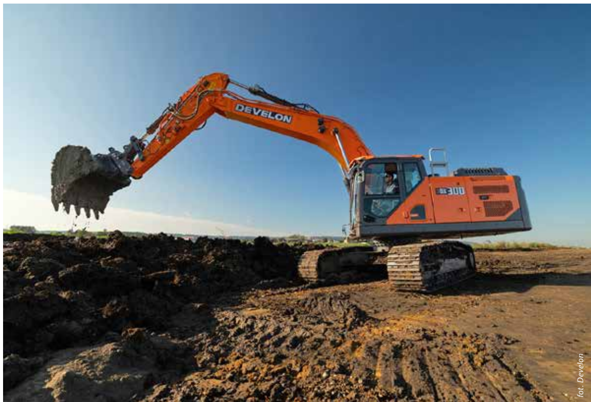
Develon DX300LC-9 to nowa 32-tonowa koparka gąsienicowa serii 9. Model wykorzystuje w pełni elektrohydrauliczny układ sterowania FEH.
