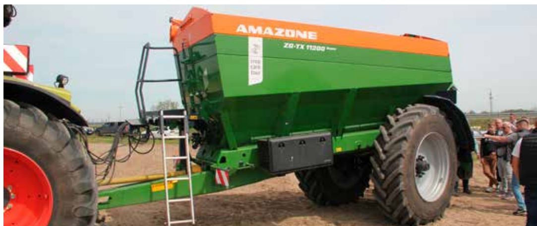
Dopuszczalna masa całkowita rozsiwacza zaczepianego Amazone ZG-TX 11200 to aż 21 ton.
